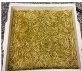
Fotografia 4: Fibra imersa em solução de hidróxido de sódio NaOH 10%, m/v.
