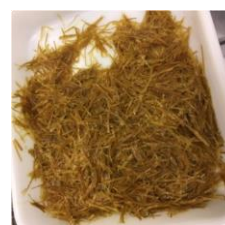
Fotografia 5: Fibra tratada e lavada com água destilada
