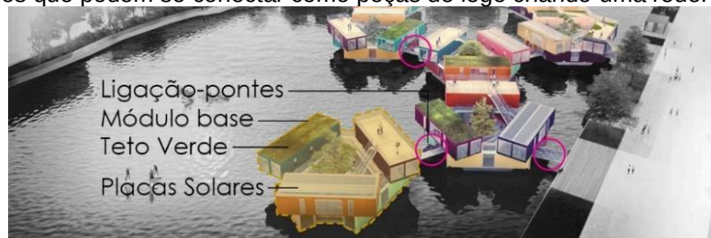
Figura 8 - Módulos que podem se conectar como peças de lego criando uma rede.
