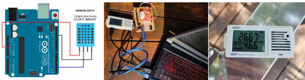
Figura 12. (a)Esquema de montagem da placa utilizada no sistema da mochila meteorológica.(b) Conexão do sensor ao notebook durante teste de calibração. (c) Equipamento Hobo.
