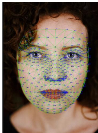
Figura 2 – Exemplo de cálculos dos 468 pontos realizadas pelo preditor do Face Mesh
