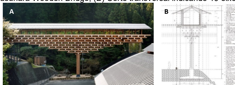
FIGURA 09: (A) Yusuhara Wooden Bridge; (B) Corte transversal indicando 19 eixos estruturais.
