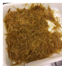
Fotografia 3: Fibra tratada e lavada com água destilada
