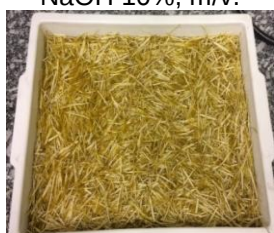
Fotografia 2: Fibra imersa em solução de hidróxido de sódio NaOH 10%, m/v.
