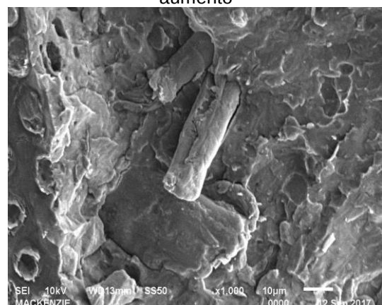
Micrografia 20 - Micrografia do Compósito C 3 : 75%PP+20%F B +5%PSB 1000 vezes de aumento
