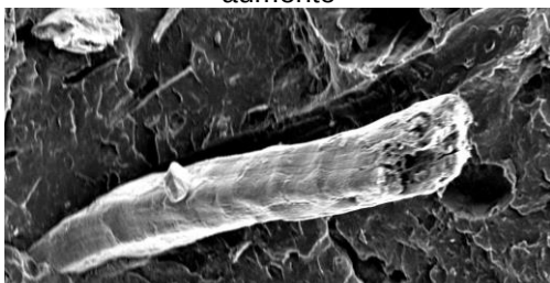
Micrografia 7 - Micrografia do Compósito C 1 : PP/10%F B /5%PSB com 500 vezes de aumento
