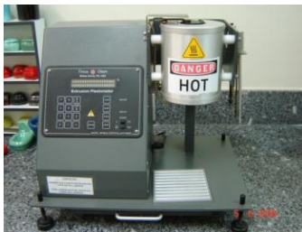
Fotografia 1 – Plastômetro Tinius Olsen MP993a.
