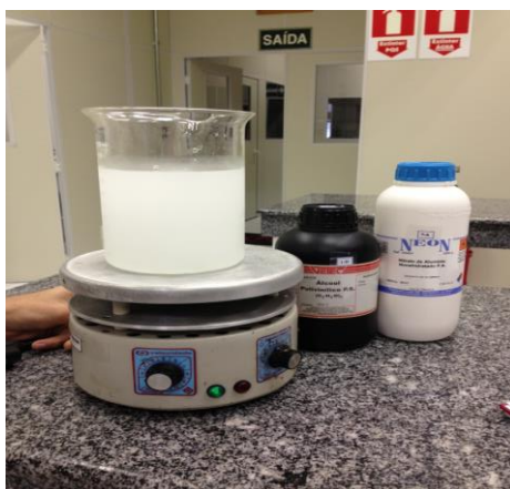
Imagem 1: Solução de nitrato de alumínio [Al(NO_3)_3 \cdot 9H_2O] , 98% em massa e solução de álcool polivinílico, 8% em massa, misturadas com a ajuda de um agitador magnético.
