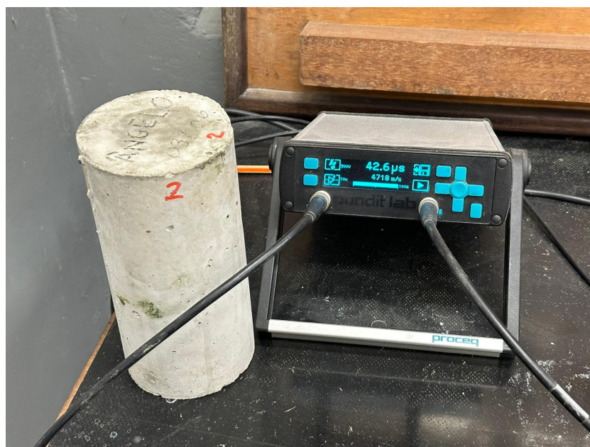
Imagem 11 - Resultados do ensaio de determinação da velocidade de propagação de onda ultrassônica do CP 2
