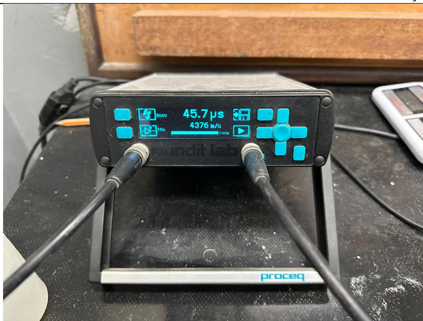
Imagem 10 – Resultados do ensaio de determinação da velocidade de propagação de onda ultrassônica do CP 1
