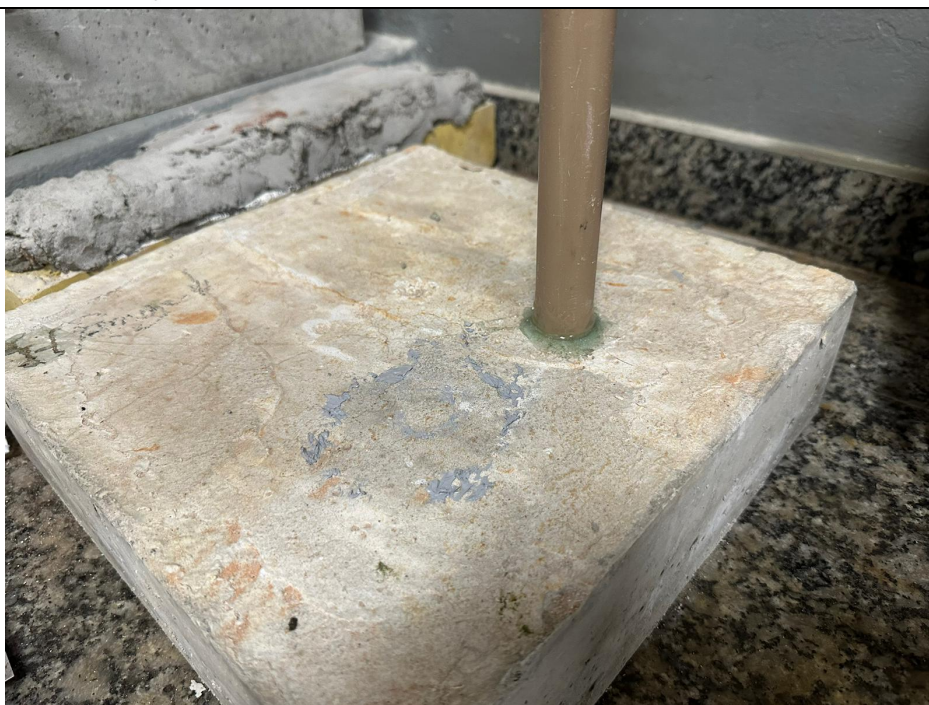
Imagem 3 – Ensaio de absorção de água
