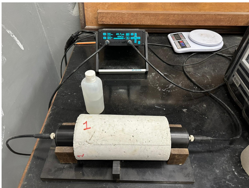
Imagem 4 – Ensaio de determinação de velocidade de propagação de onda ultrassônica
