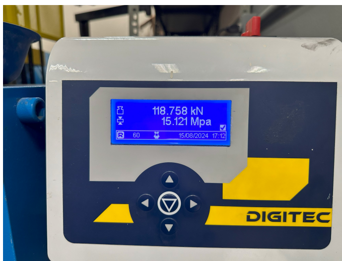
Imagem 7 – Resultado do ensaio de resistência a compressão
