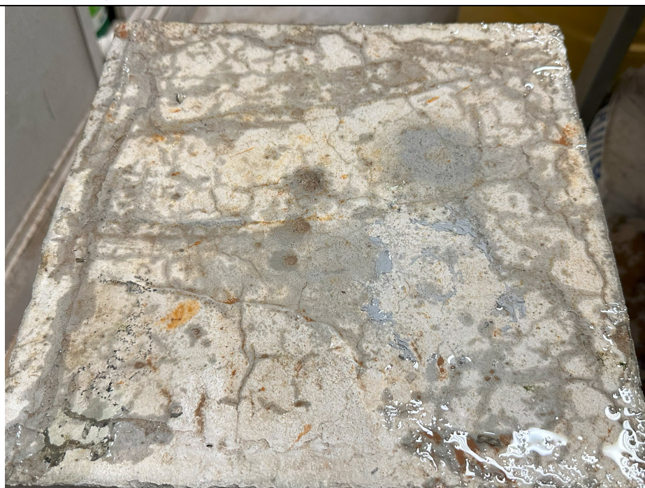
Imagem 12 - Amostra com a água em contato com a superfície onde foi aplicado o produto
