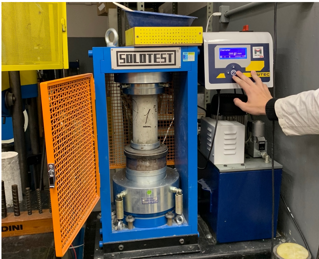
Imagem 2 – Ensaio de Resistência a Compressão
