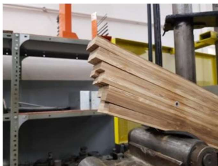
Figura 2. Ruptura por esgotamento de tensão de cisalhamento
