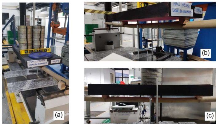
Figura 12 – Comportamento dos colmos de bambu durante o ensaio.
