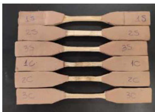
Figura 6. Amostras utilizadas para a realização do ensaio de tração.
