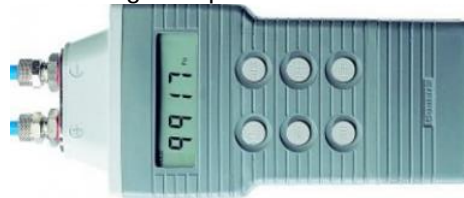
Figura 06 – Medidor manométrico de engate rápido
