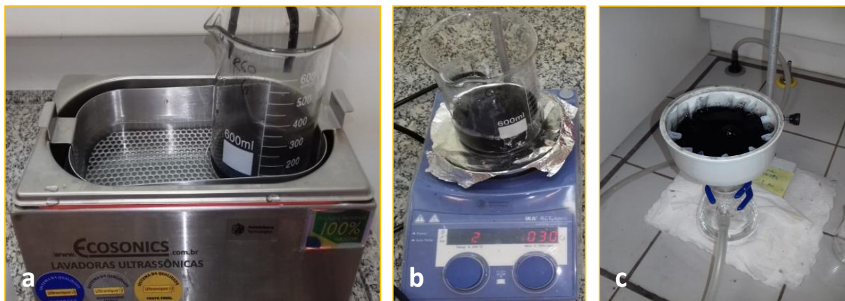
Figura 6 – Sequência para obtenção do Óxido de Grafeno Reduzido.
