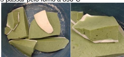
Fotografia 4: Pó de vidro após passar pelo forno a 850°C
