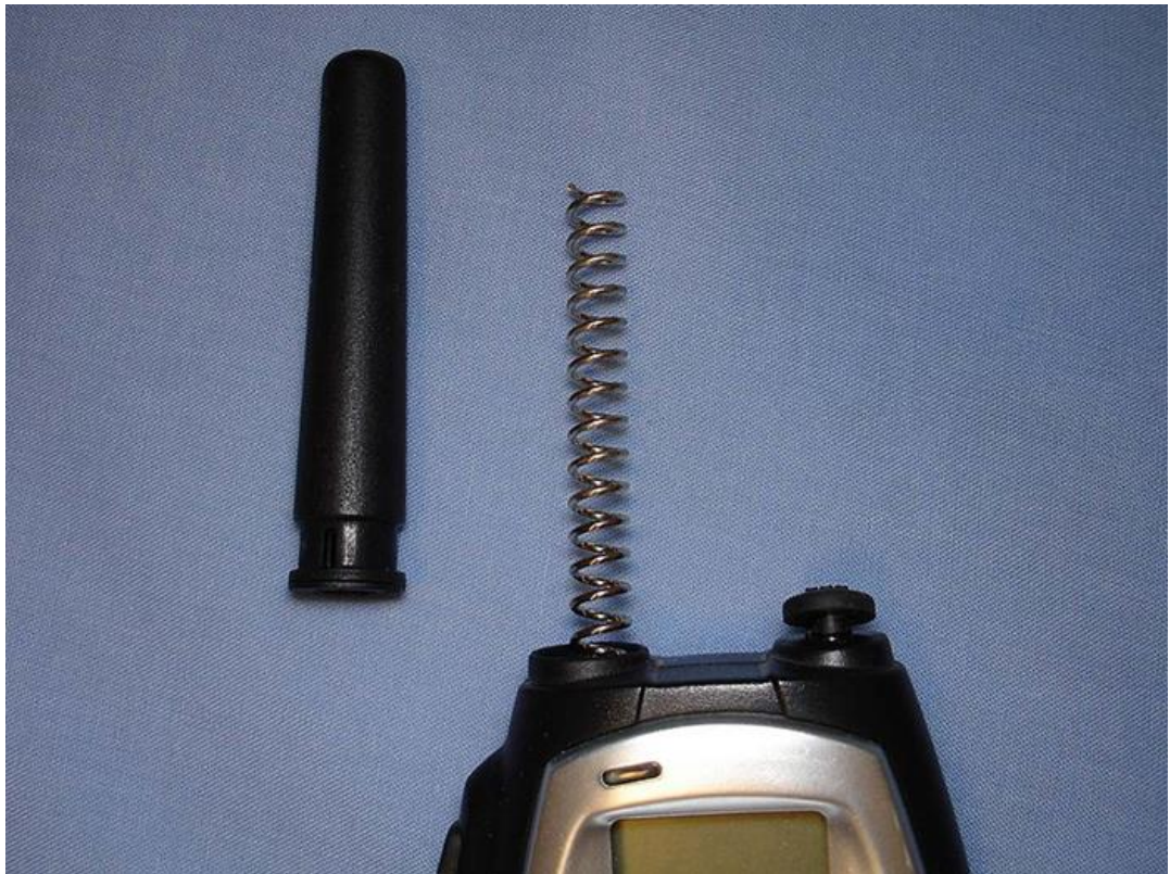
Figura 2 - Antena helicoidal utilizada em um dispositivo móvel operando em UHF (477 MHz).
