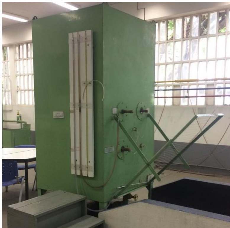
Figura 3 – Bancada de Orifícios e Bocais CTH-USP
