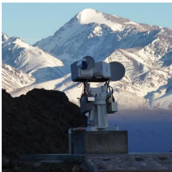
Figura 2: Sistema de radiospolarímetros POEMAS, cada um funciona a 45GHz e 90GHz com as polarizações à direita e à esquerda. Instalado no observatório El Leoncito nos Andes, na Argentina.
