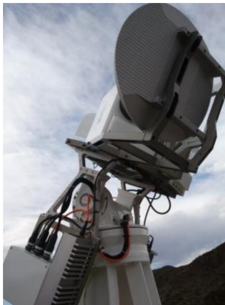
Figura 4: Foto da estrutura de suporte (em cinza) instalada no POEMAS, como forma de diminuir o impacto dos ventos.
