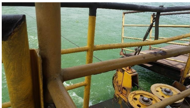
Figura 4: Sistema de tração da balsa do Bororé. Fonte: Autora.
