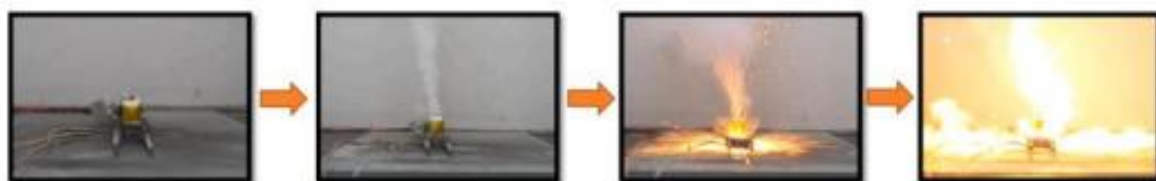
Figura 1 – Exemplo de uma fuga térmica
