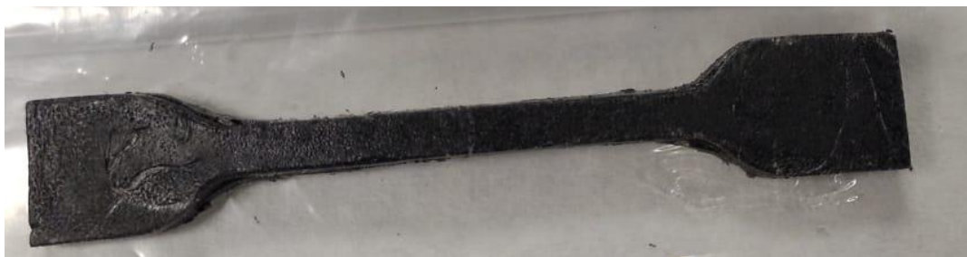
Figura 3 – Blenda Polimérica PS e PEBD 75% e 25% de acordo com norma ASTM D 638 (1999)
