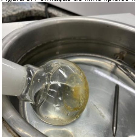
Figura 3: Formação de filme lipídico na parede do balão
