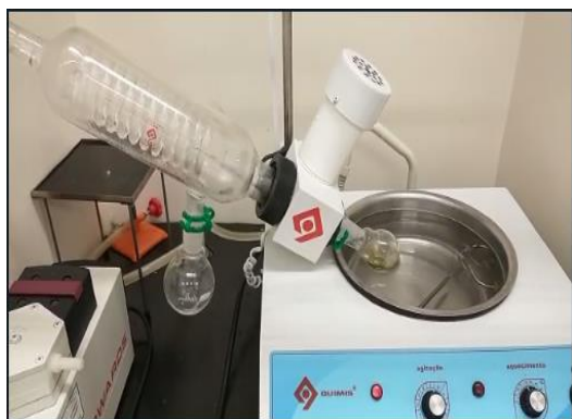
Figura 4: Mistura de lecitina, óleo de abacate e clorofórmio no rotoevaporador
