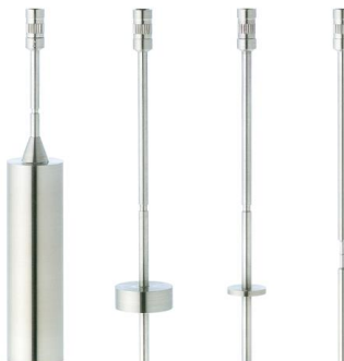
Imagem 1: Spindles numerados de 1 a 4, da esquerda para a direita, utilizados no aparelho de Brookfield
