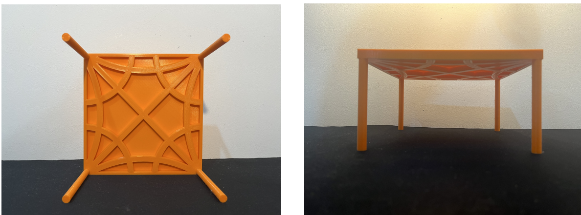
Figura 20: Fotografia do módulo quadrangular da laje nervurada;
