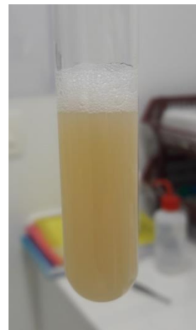
Figuras 6 e 7: solução de etanol 20% homogeneizada com filme lipídico, em béquer e em tubo de vidro.
