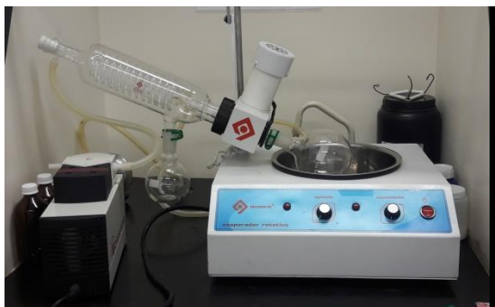
Fig. 3: Rotoevaporador QUIMIS Q344B2 (sistema completo com bomba à vácuo)
