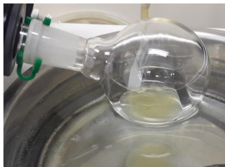
Fig. 4: Solução de clorofórmio e lecitina no balão de vidro submetida à rotoevaporação
