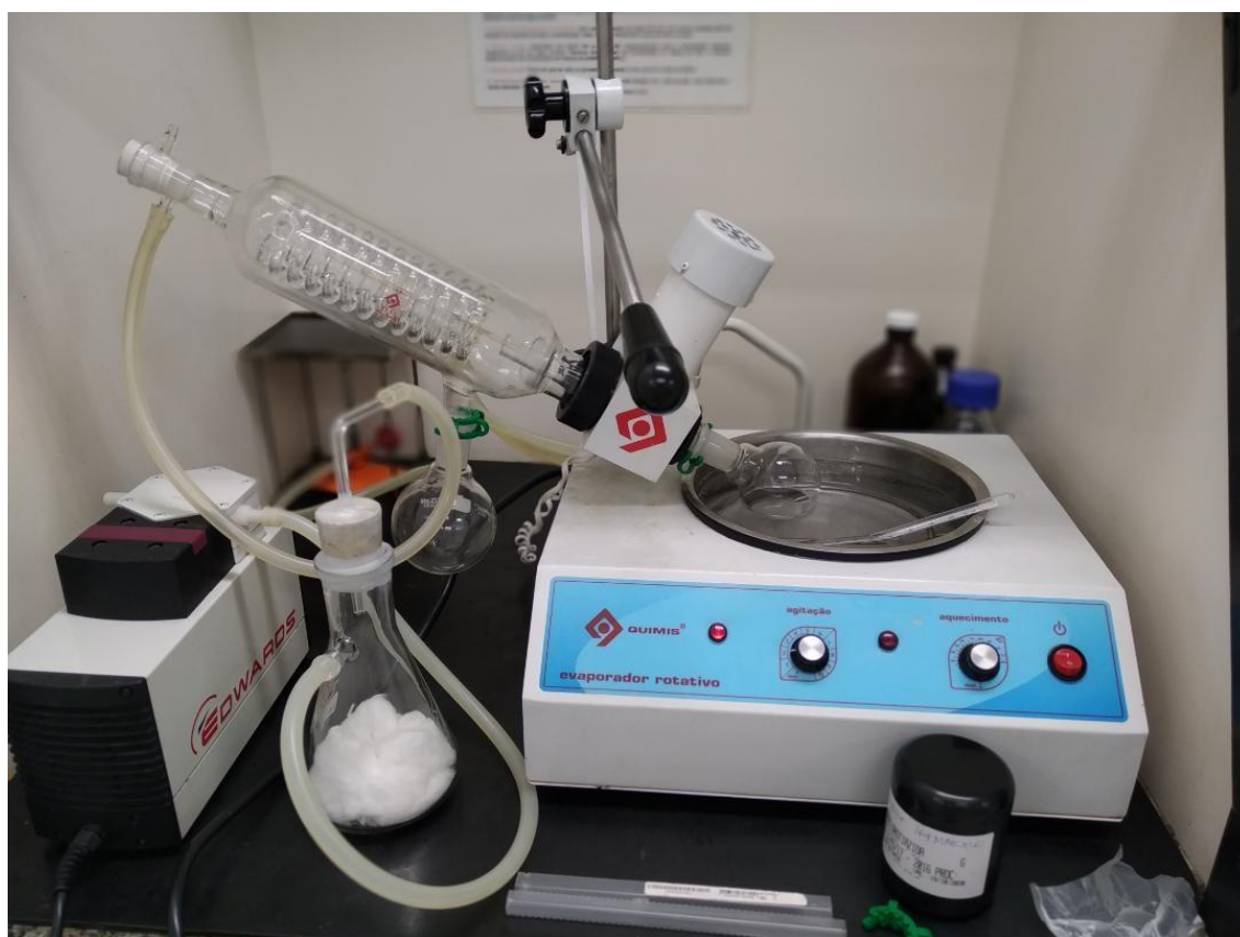
Figura 2: Roto evaporador. Fonte: Laboratório Semi-industrial do curso de Farmácia da UPM (Universidade Presbiteriana Mackenzie).
