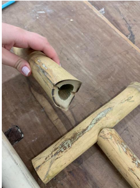
Figura 4 - Documentação de fissuras - Imagem autoral
