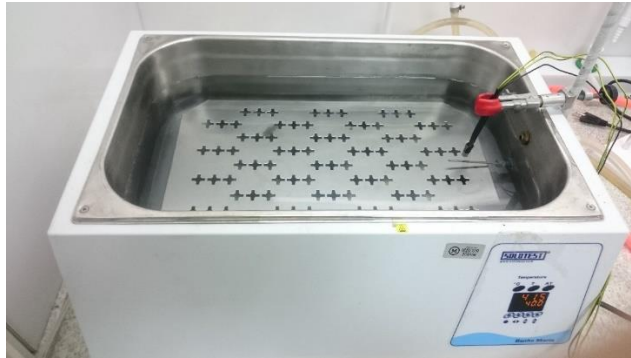
Figura 14. Equipamento para banho de imersão
