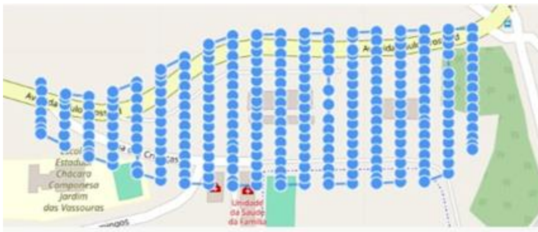
Figura 6 – Rota de voo e posicionamento das fotos
