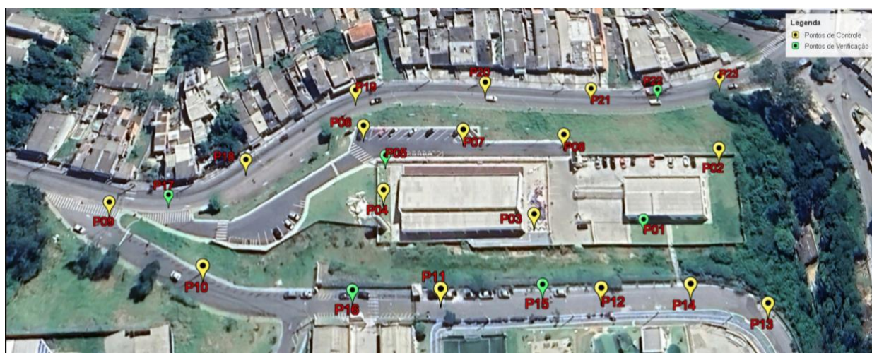
Figura 4 – Pontos de Apoio (Controle e Verificação) – Creche das Artes
